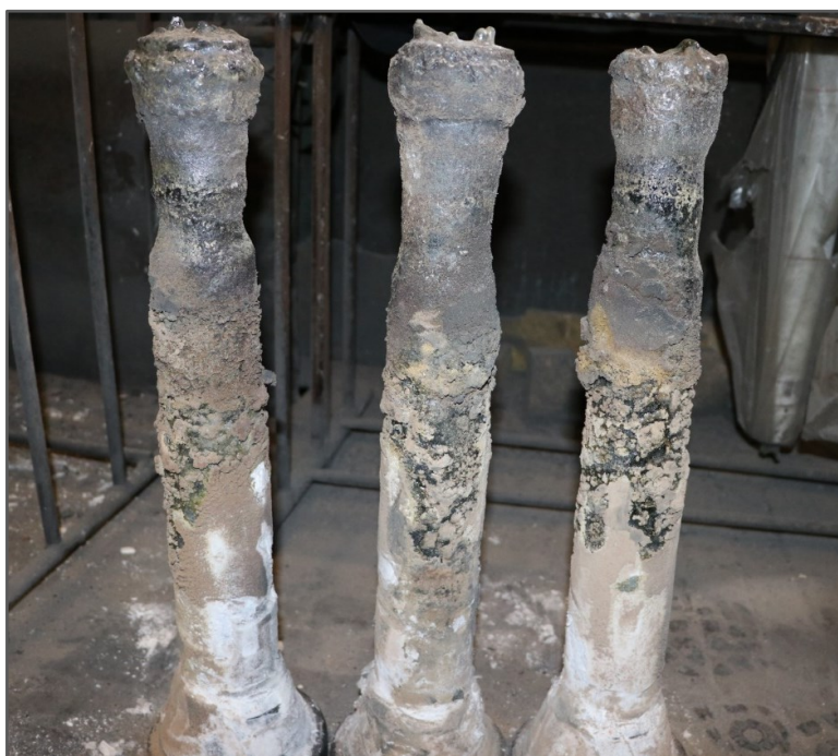
Obr. 5 Trojica ponorných trubíc po 17-tavbovej sekvencii (1065 minút odlievania)
