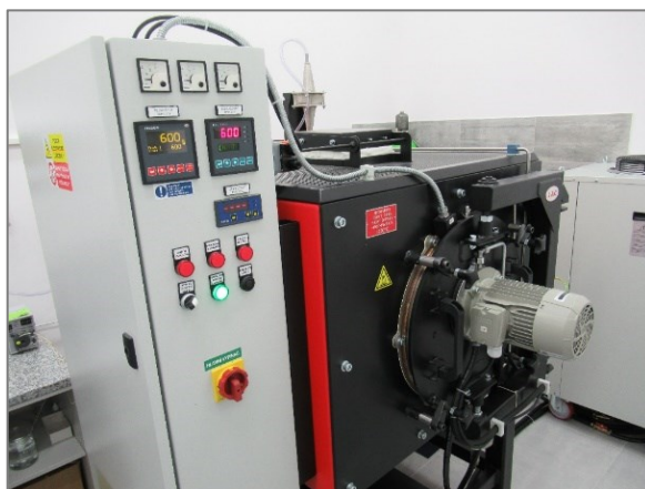
Obr. 12 Zariadenie na korózne skúšky, umiestnené v spoločnom pracovisku LVKP
