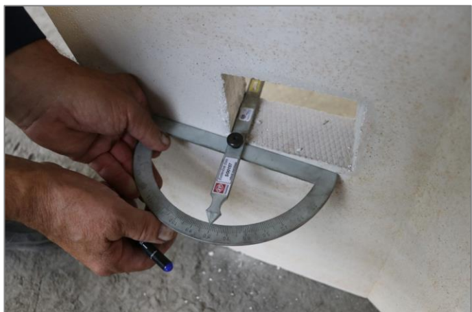
Obr. 3 Vychýlenie otvorov v priečke medzipanvy
