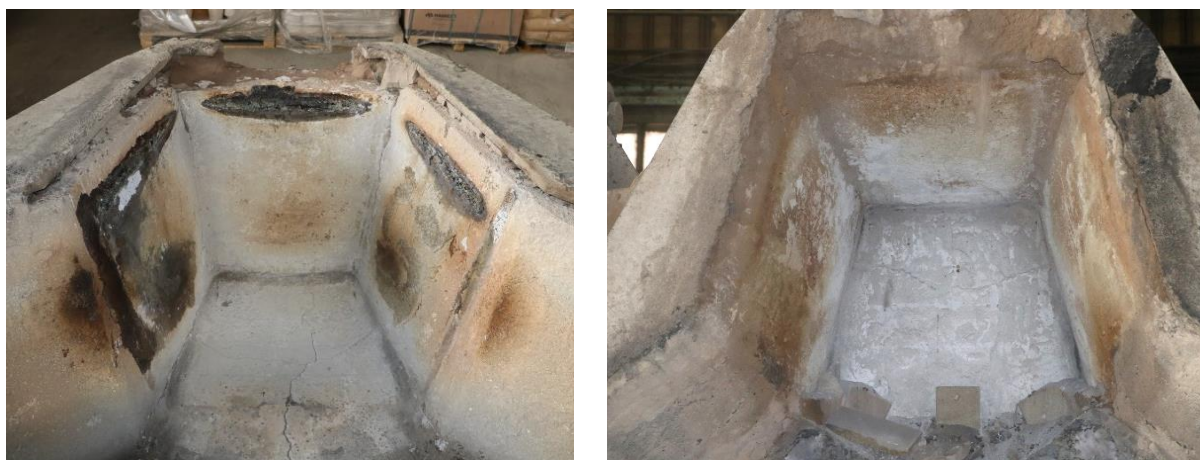
Obr. 4 Trvalá výmurovka po 16-tavbovej sekvencii s torkrétom (vľavo), po 18-tavbovej sekvencii s monolitom (vpravo)
