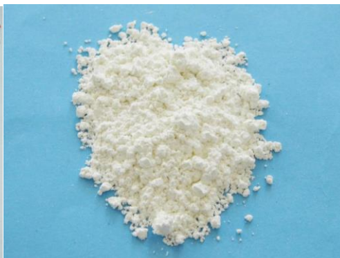
Obr. č. 23 Výsledný ZnO vyrobený v laboratórnych podmienkach
