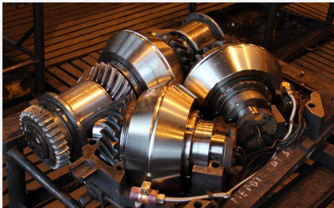
Obr. 10 Stojan redukovne s novým chladením valcov
