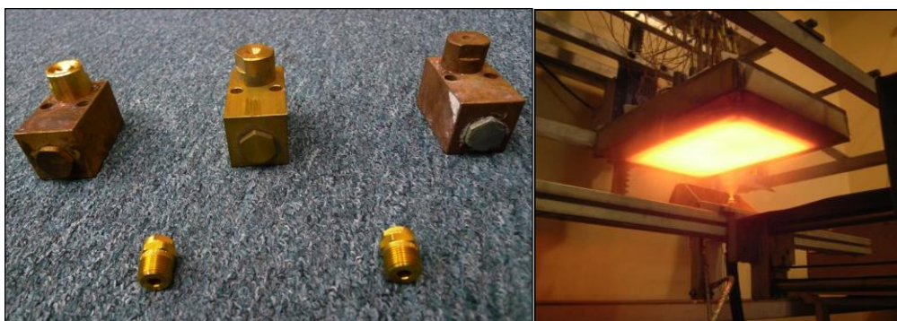
Obr. 14 Trysky LECHLER (vľavo), priebeh experimentu (vpravo)
