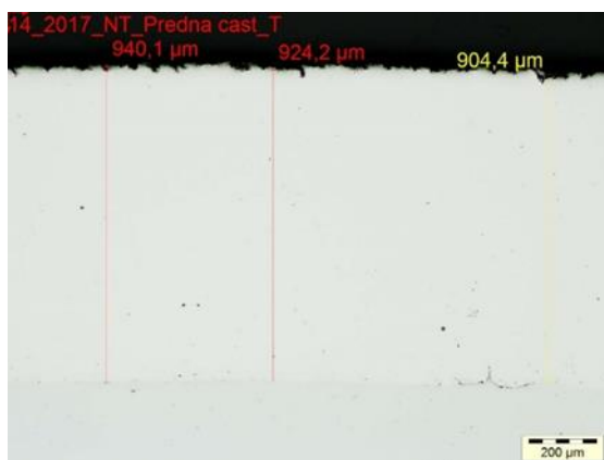
Obr. 11 hrúbka austenitickej vrstvy
