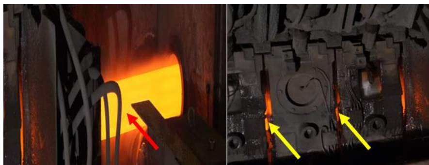
Obr. 8 Miesto merania povrchovej teploty lupy (vľavo – pred ostrekom okují, vpravo – medzi stojanmi ťahovej redukovne)
