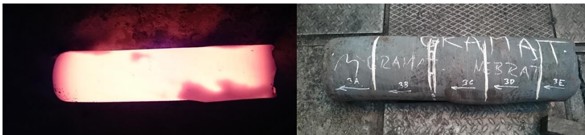
Obr. 10 Vývalok č. 3 - oddelená austenitická vrstva prejavená jej vydutím (tmavšia oblasť)
