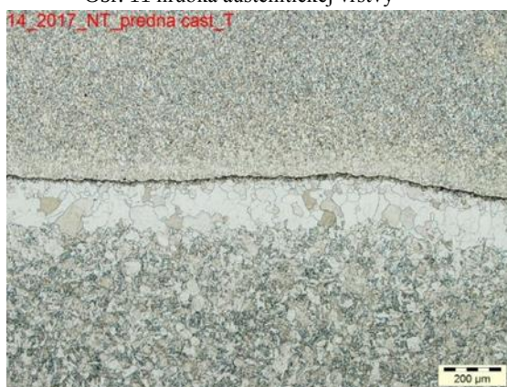
Obr. 13 úplné oduhličenie pod rozhraním
