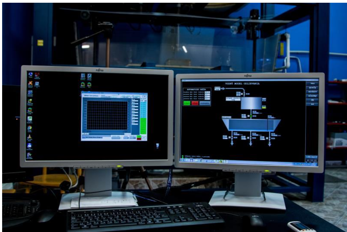
Obr. 38 Operátorská PC stanica pre snímanie, záznam a vizualizáciu veličín a riadenie prietokov
